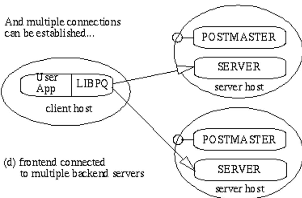
(d) frontend connected to multiple backend servers
